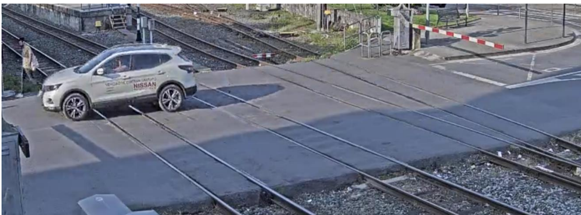
Vehículo "atrapado" en paso a nivel con semibarreras bajadas
